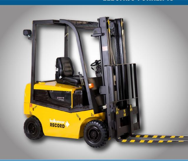
RATED CAPACITY 1500-2500 kg LOAD CENTER 500-600 mm LIFTING HEIHGT 3000-7000 mm
